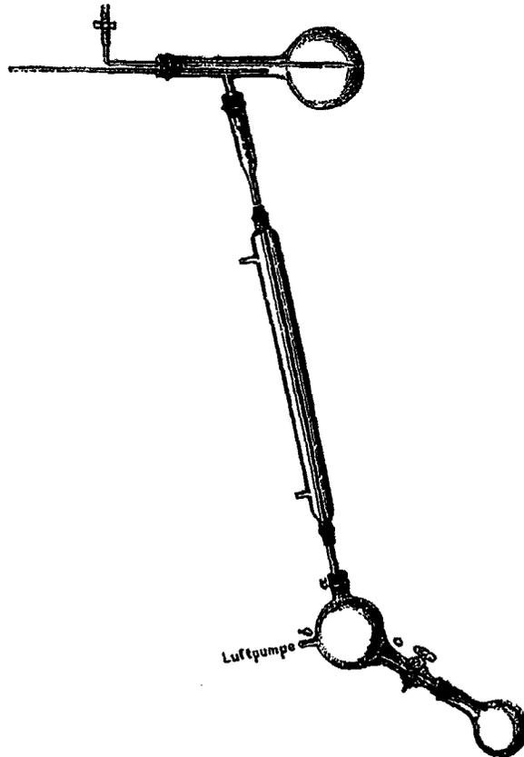
fangekölbchen mit der atmosphärischen Luft auf gleichem Druck (während natürlich der übrige Theil des Apparates vollständig evacuirt bleibt), ersetzt dasselbe durch ein neues, dreht den Hahn in seine frühere Lage zurück und destillirt weiter. Hat man vorher einige Kölbchen von gleicher Halsweite ausgesucht, die somit alle luftdicht auf denselben Gummistopfen passen, so geht dieser Wechsel sehr rasch von Statten.
